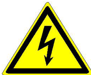
Рис. 8. Опасность поражения электрическим током
